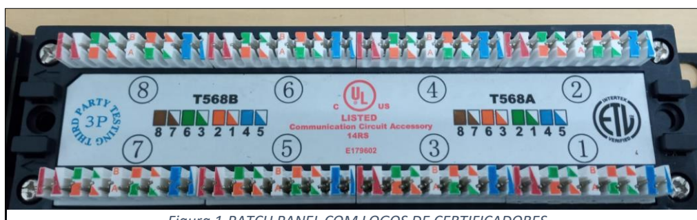
Figura 1-PATCH PANEL COM LOGOS DE CERTIFICADORES
